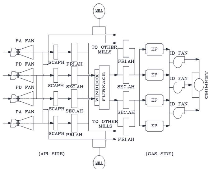
FIGURE 4 : AIR AND GAS SYSTEM – TYPICAL
